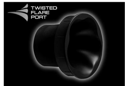
Yamaha 研发的 Twisted Flare Port 改变了这种构造, 出音孔向其末端逐渐增宽, 同时加入了 “扭曲” 构造, 以此抑制每个连通出音孔末端的空气紊流, 藉此防止了噪音的出现。
